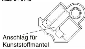
Kabel kürzen und vorbereiten. Bei eingeputzten Kabeln auf eine Mindestlänge von ca. 140 mm bis zur Wand achten!
