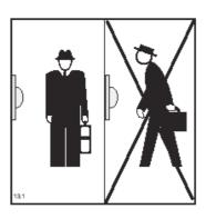
Störquellen, z.B. Lampen oder Heizungen im Erfassungsfeld der Geräte ausschließen. (siehe Hinweis "Anwendung der Aufsteckblende")
