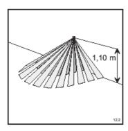
Die optimale Reichweite wird erreicht, wenn der Sensor seitlich zur Gehrichtung montiert wird.
