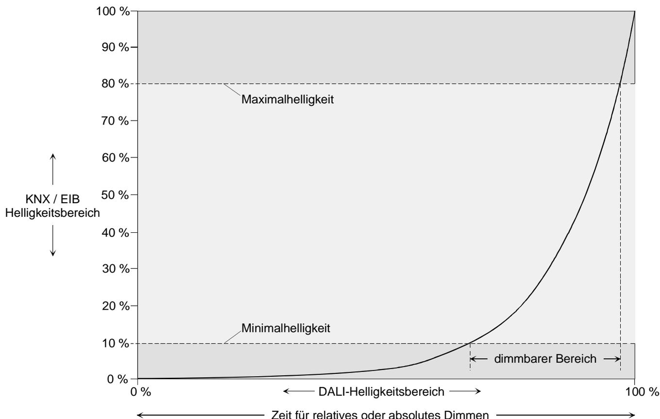
Bild 18: Dimmkennlinie für relatives oder absolutes Dimmen
