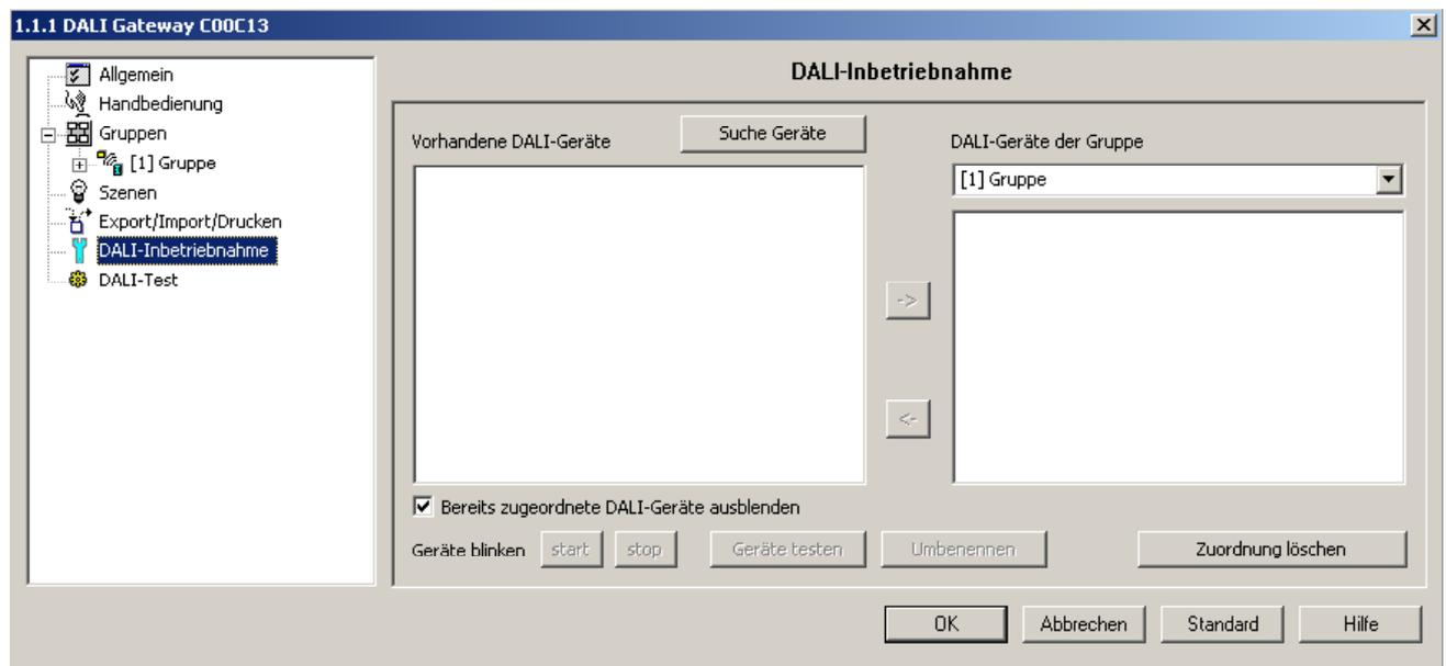
Bild 34: DALI-Inbetriebnahmeumgebung im ETS 3 Plug-In beispielhaft am Applikationsprogramm mit der Version "0.3" oder "1.3"
