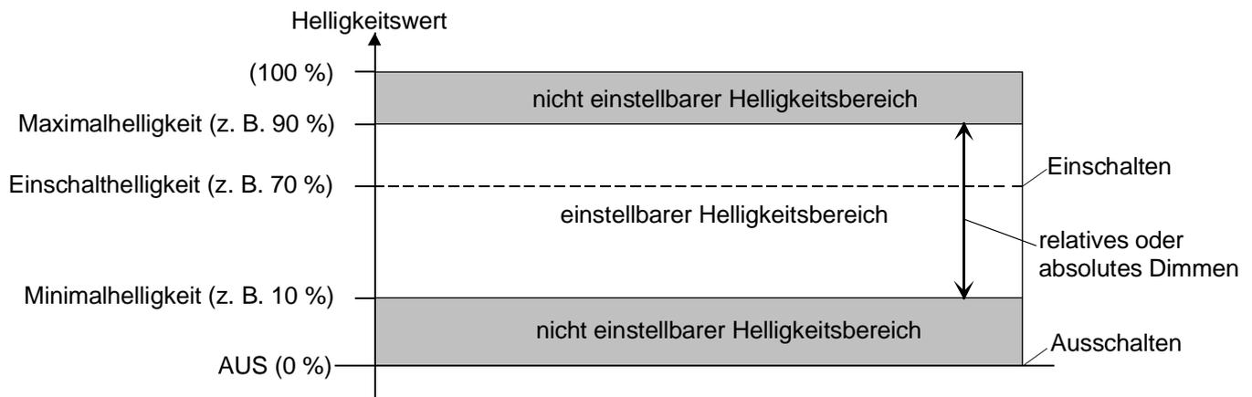
Bild 13: Beispiel eines Helligkeitsbereiches mit Einschaltheelligkeit einer DALI-Gruppe
