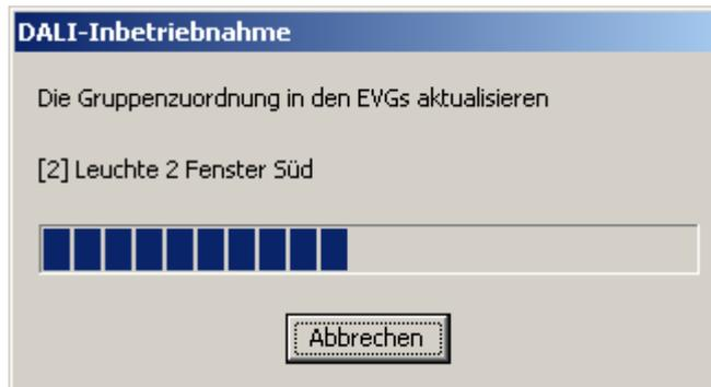
Bild 45: Abgleich der Inbetriebnahmeparameter zwischen Gateway und DALI-Betriebsgerät
