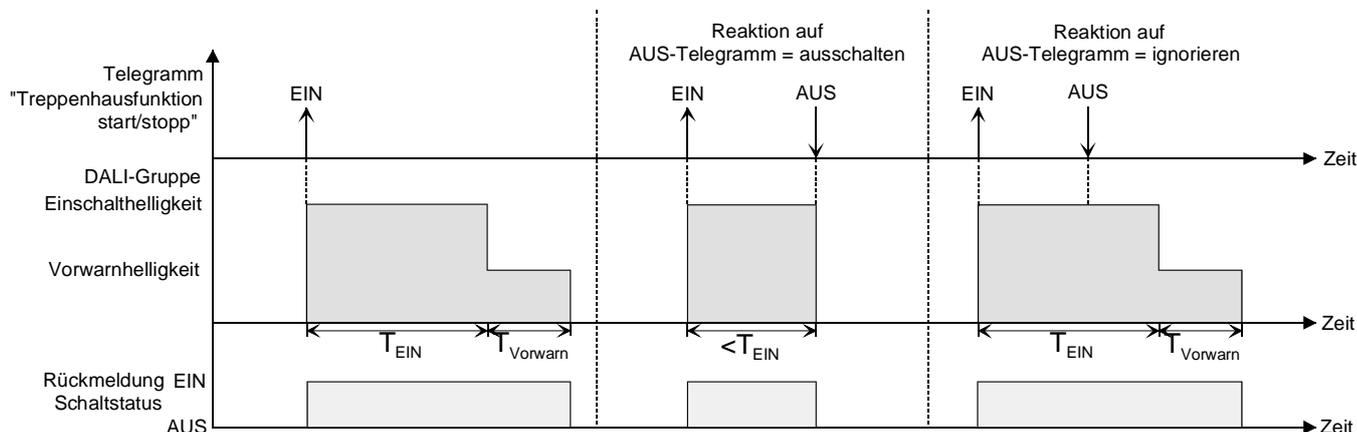
Bild 27: Ausschaltverhalten der Treppenhausfunktion ohne Soft-Funktionen
