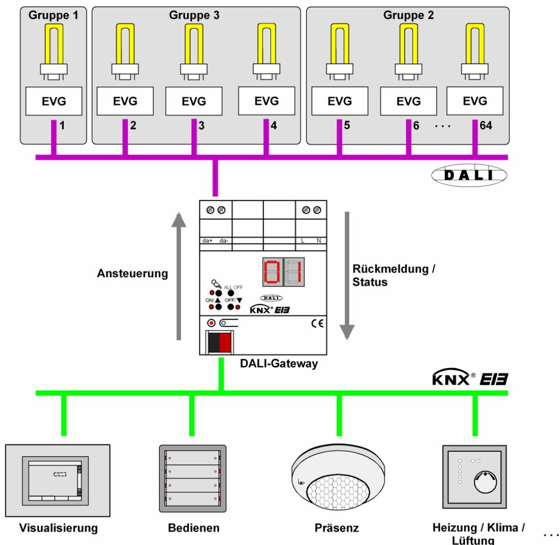
Bild 6: Prinzipübersicht einer KNX/EIB-DALI-Systemanbindung
