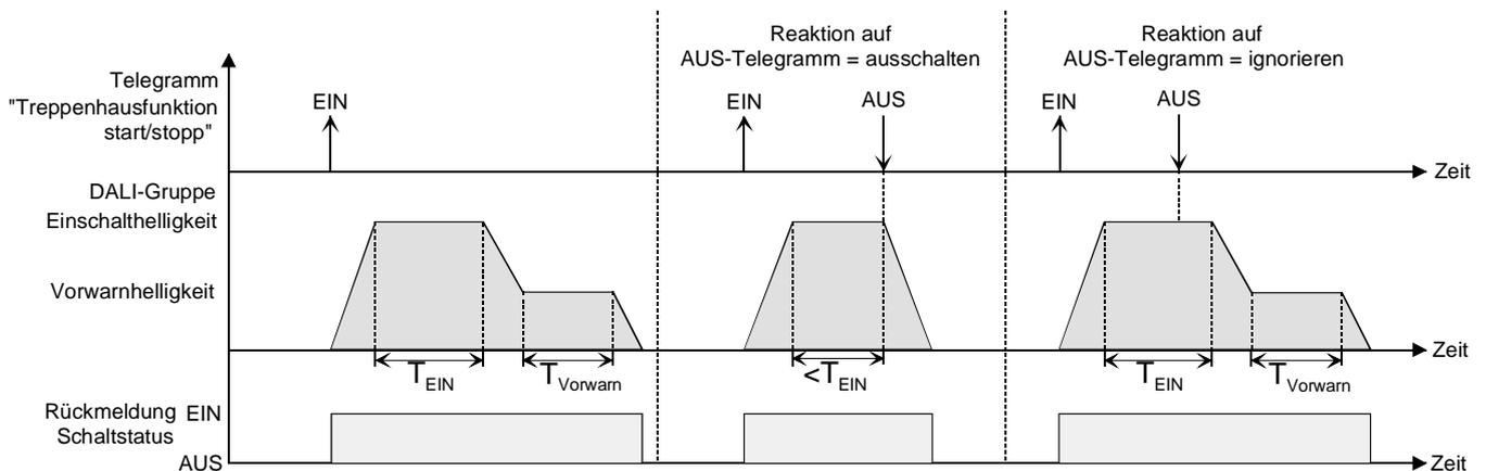
Bild 28: Ausschaltverhalten der Treppenhausfunktion mit Soft-Funktionen
