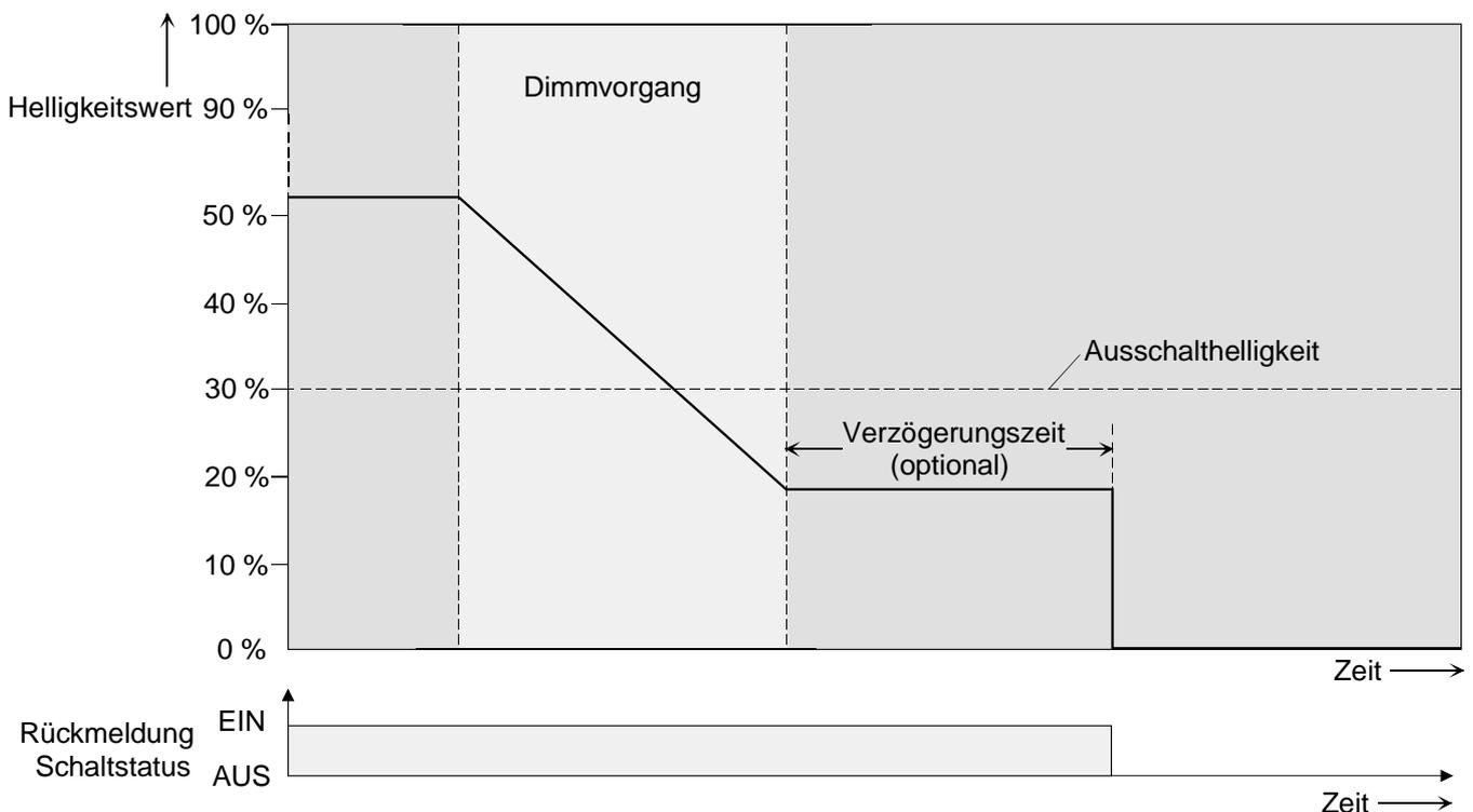
Bild 19: Dimm- und Schaltverhalten der automatischen Ausschaltfunktion
