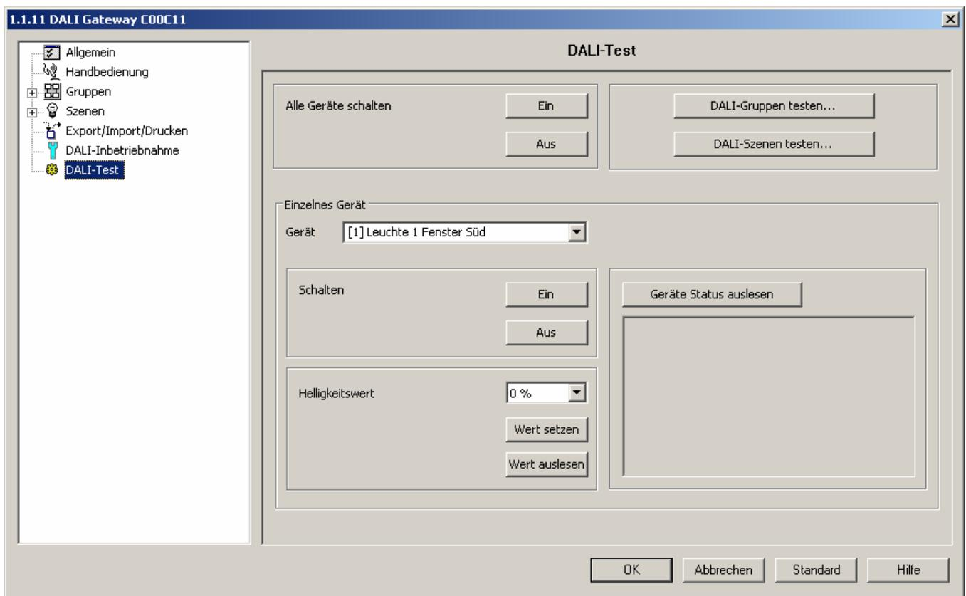
Bild 46: DALI-Testumgebung im ETS 3 Plug-In
