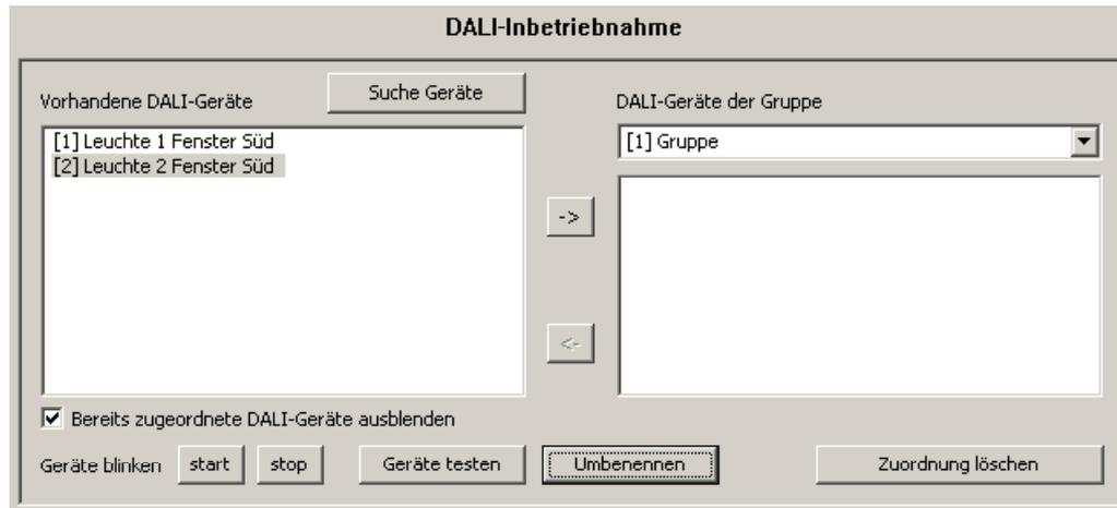
Bild 38: Beispiel für Namensgebung der identifizierten Betriebsgeräte
