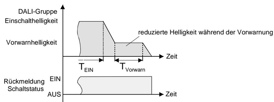
Bild 30: Die Vorwarnfunktion der Treppenhausfunktion mit Soft-AUS-Funktion
