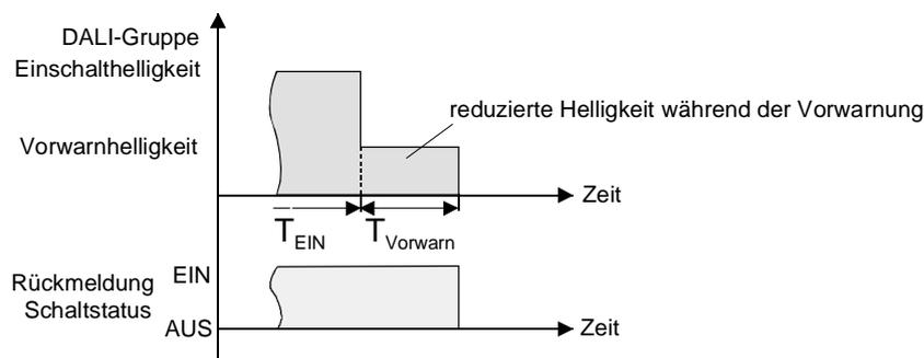
Bild 29: Die Vorwarnfunktion der Treppenhausfunktion ohne Soft-AUS-Funktion
