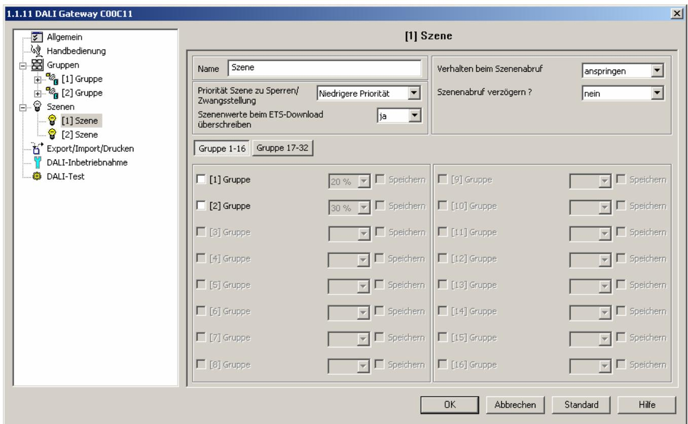
Bild 31: Konfigurationsseite einer Szene
