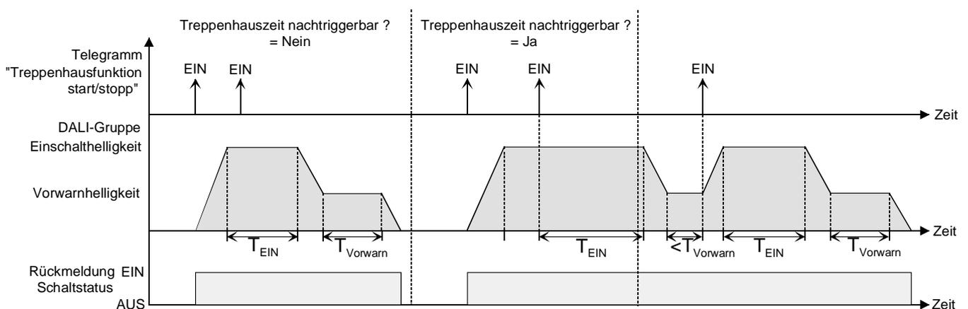
Bild 26: Einschaltverhalten der Treppenhausfunktion mit Soft-Funktionen
