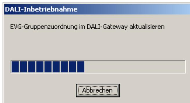
Bild 44: Abgleich der Inbetriebnahmeparameter zwischen Plug-In und DALI-Gateway
