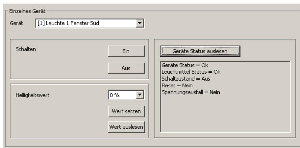
Bild 47: Geräteorientierte DALI-Testumgebung
