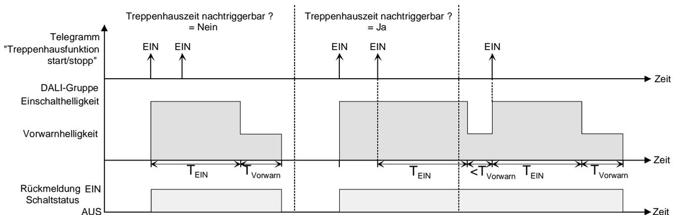
Bild 25: Einschaltverhalten der Treppenhausfunktion ohne Soft-Funktionen
