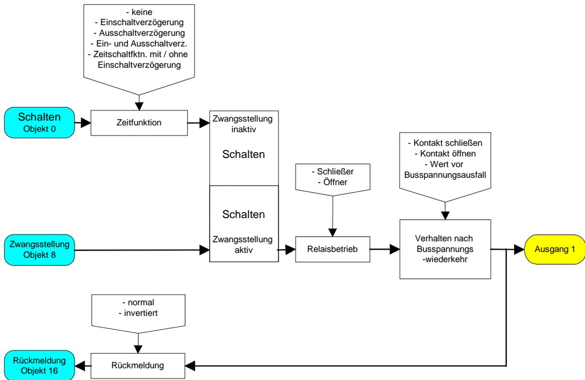
Funktionsschaltbild (für Schaltausgänge / z. B. Ausgang 1 mit der Zusatzfunktion "Zwangsstellungsobjekt")
