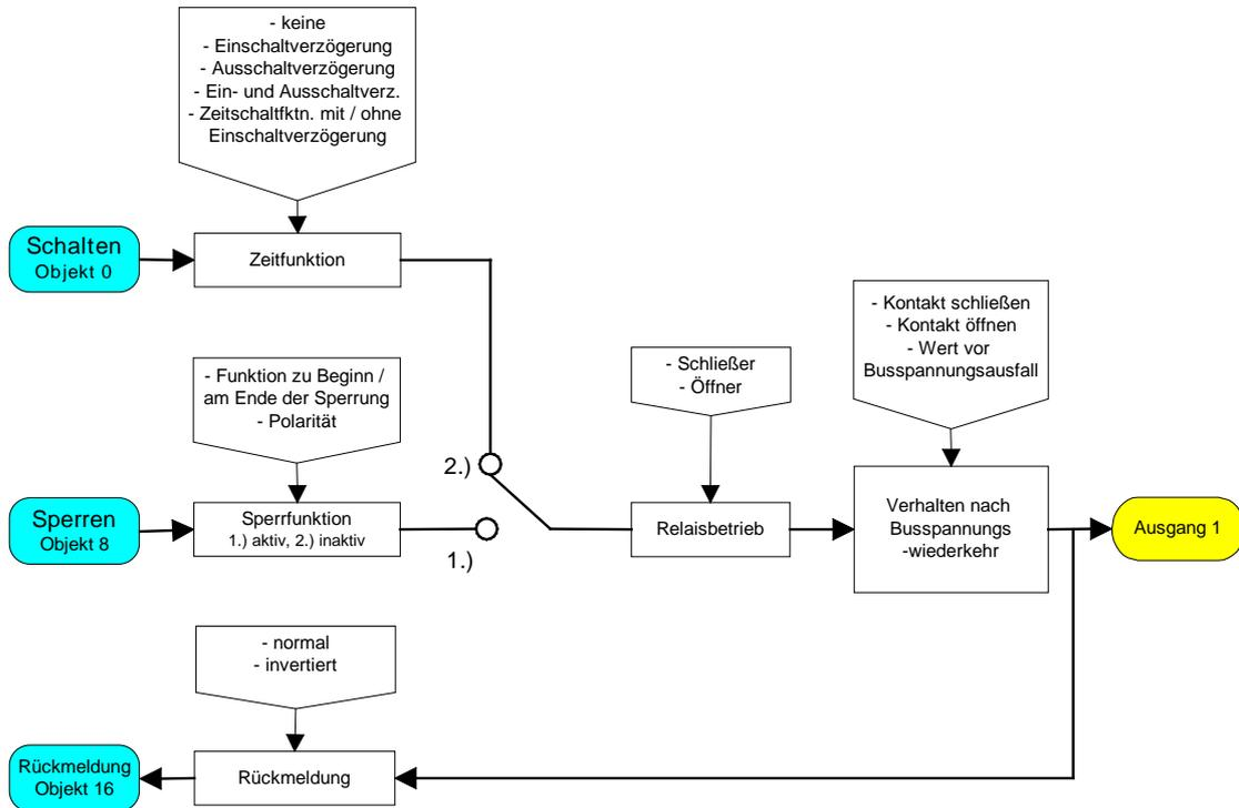
Funktionsschaltbild (für Schaltausgänge / z. B. Ausgang 1 mit der Zusatzfunktion "Sperrobject")
