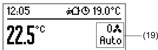
Bild 59: Beispiel einer 2-Bereichs-Anzeige mit Raumtemperatur in der Menüfläche und Lüfterstufenanzeige
