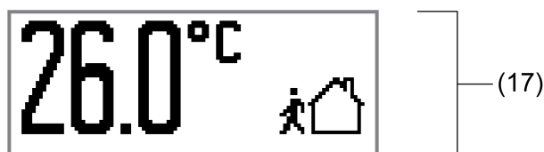
Bild 57: Beispiel für eine Grundanzeige mit einem Anzeigebereich (Raumtemperatur, Betriebsmodusanzeige)
