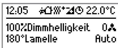
Bild 62: Beispiel einer 2-Bereichs-Anzeige mit 2-zeiliger Wertanzeige inkl. ergänzendem Text Zeile 1 Helligkeitswert, Zeile 2 Lamellenwinkel
