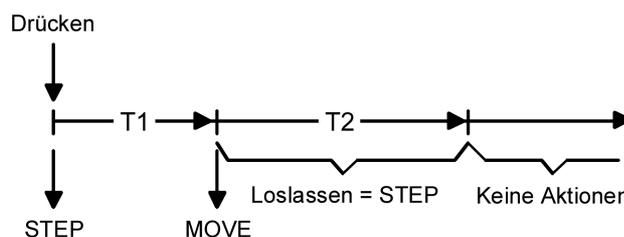
Bild 8: Bedienkonzept "Kurz - Lang - Kurz"
