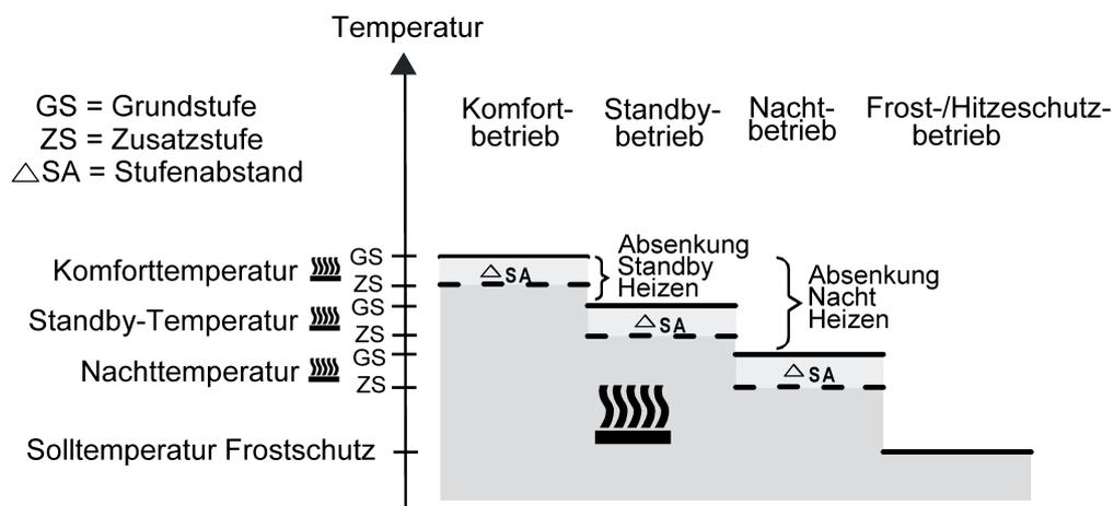
Bild 31: Solltemperaturen in der Betriebsart "Grund- und Zusatzheizen"
