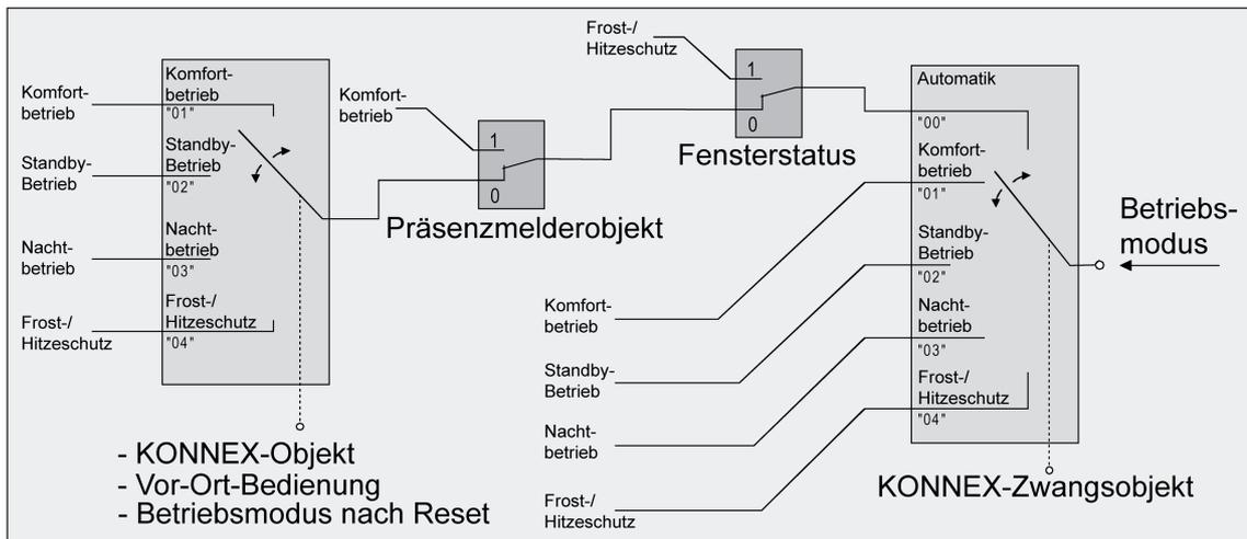
Bild 29: Betriebsmodusumschaltung durch KONNEX Objekt mit Präsenzmelder
