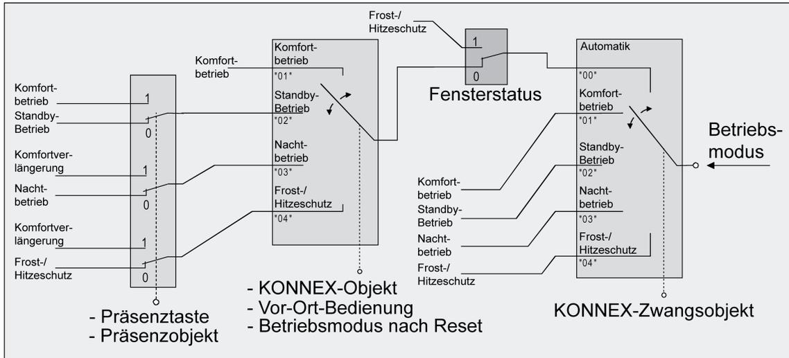
Bild 28: Betriebsmodusumschaltung durch KONNEX Objekt mit Präsenztaste
