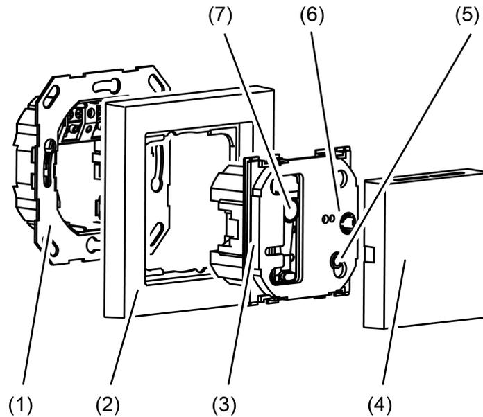
Bild 1: Geräteaufbau CO<sub>2</sub>-Sensor
