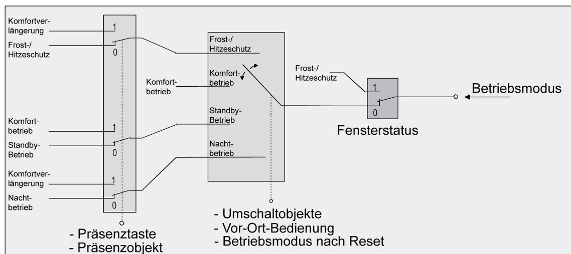
Bild 26: Betriebsmodusumschaltung durch 4 x 1 Bit Objekte mit Präsenztaste
