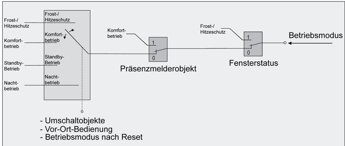
Bild 27: Betriebsmodusumschaltung durch 4 x 1 Bit Objekte mit Präsenzmelder
