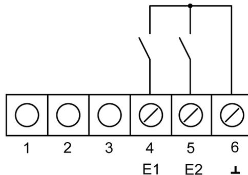
Bild 4: Anschluss Binäreingänge
