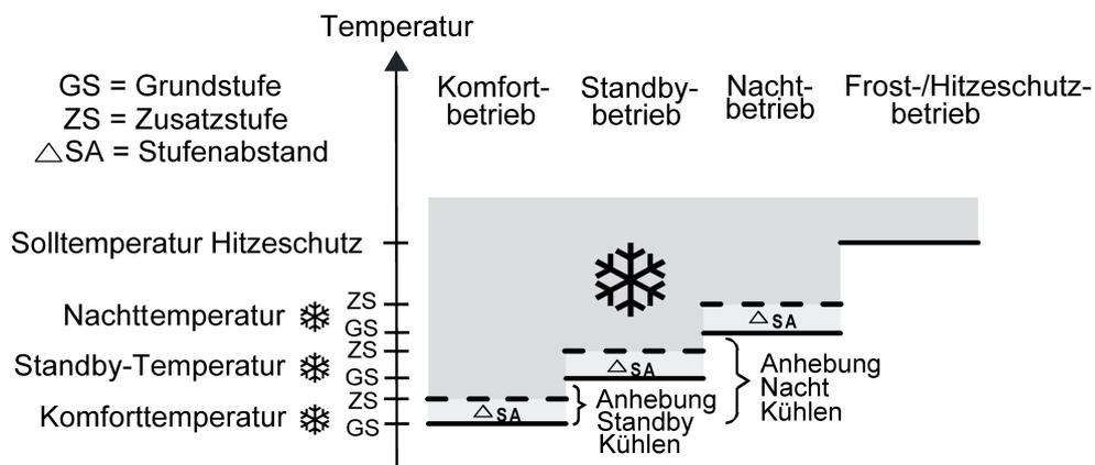
Bild 33: Solltemperaturen in der Betriebsart "Grund- und Zusatzkühlen"
