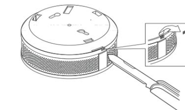
2. Den Rauchwarnmelder auf der Montageplatte arretieren (aufstecken und Drehung im Uhrzeigersinn). Die Demontage erfolgt in umgekehrter Reihenfolge (Drehung gegen den Uhrzeigersinn und abziehen).
