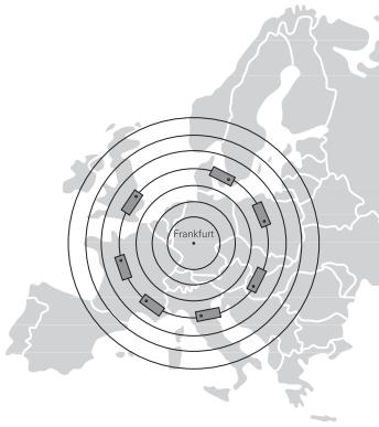
Die Physikalisch-Technische Bundesanstalt (PTB) in Braunschweig betreibt eine der genauesten Cäsium-Atomuhren der Welt. Sie weicht weniger als eine Sekunde in 300.000 Jahren ab. Uhrzeit und Datum werden über den Langwellensender DCF77 von Mainflingen bei Frankfurt/Main auf einer Frequenz von 77,5 kHz ausgestrahlt.
