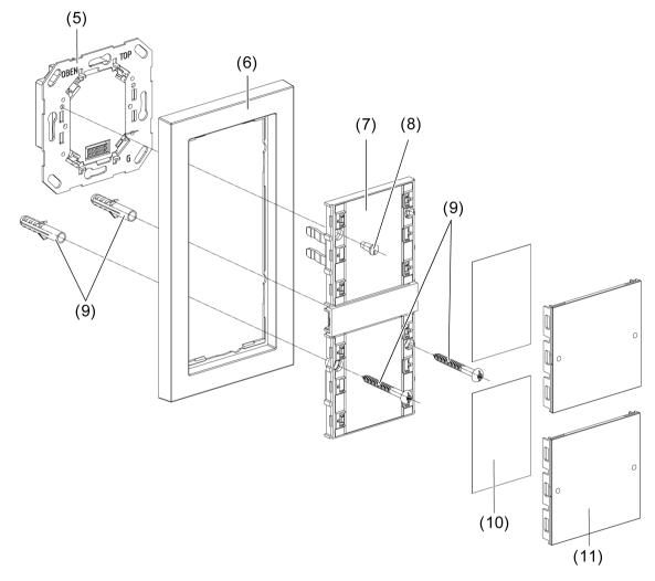
Bild 4: Gerätemontage am Beispiel eines Tastsensors 3 komfort 2fach (mit Rahmen ohne Mittelsteg)
