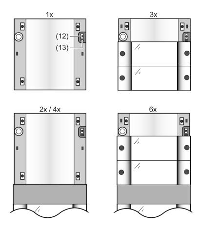
Bild 5: Anordnung der Programmiertaste und -LED auf der Gerätefront
