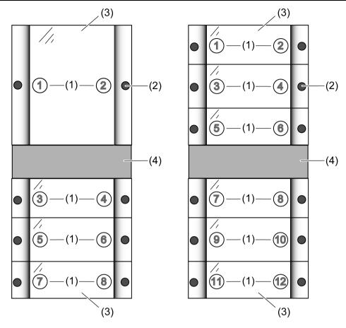
Bild 2: Geräteaufbau Tastsensoren 3 komfort - Varianten 4fach und 6fach
