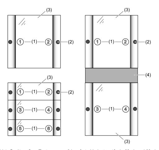
Bild 1: Geräteaufbau Tastsensoren 3 komfort - Varianten 1fach, 2fach und 3fach
