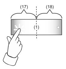
Bild 9: Beispiel für eine Tastenbetätigung bei konfigurierter Zweiflächenbedienung
