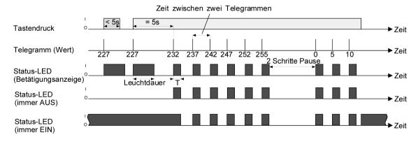
Bild 16: Beispiel zur Wertverstellung mit Wertbereichs-Überlauf
