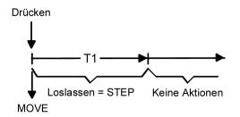
Bild 12: Bedienkonzept "Lang - Kurz"
