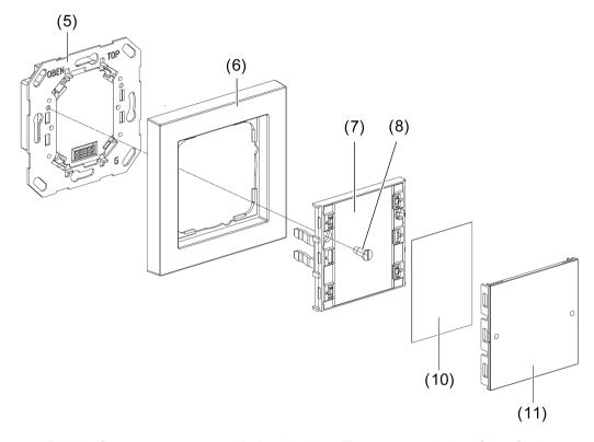
Bild 3: Gerätemontage am Beispiel eines Tastsensors 3 komfort 1fach
