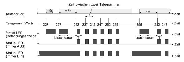
Bild 15: Beispiel zur Wertverstellung ohne Wertbereichs-Überlauf
