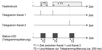
Bild 18: Beispiel zum Bedienkonzept "Kanal 1 und Kanal 2"
