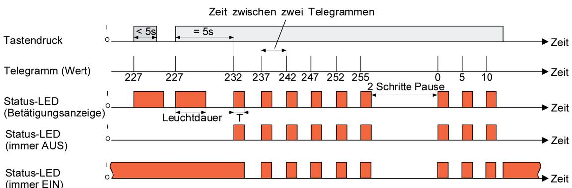
Bild 30: Beispiel zur Wertverstellung mit Wertbereichs-Überlauf
