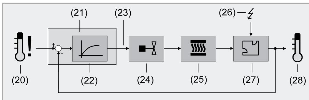
Bild 33: Regelstrecke einer Einzelraum-Temperaturregelung
