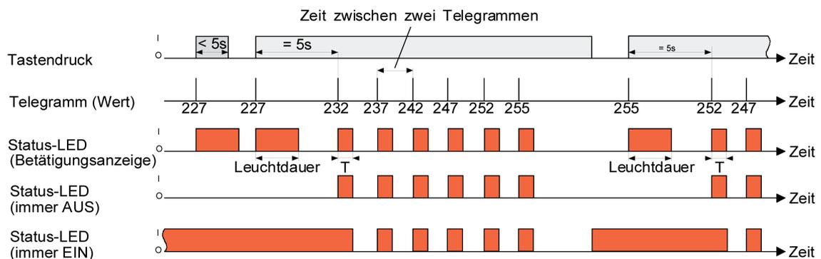
Bild 29: Beispiel zur Wertverstellung ohne Wertbereichs-Überlauf
