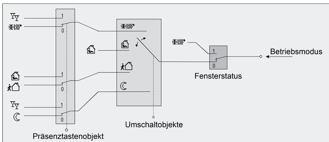
Bild 42: Betriebsmodusumschaltung durch 4 x 1 Bit Objekte mit Präsenztaste
