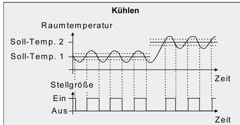
Bild 37: 2-Punkt-Regelung für Einzelbetriebsart "Kühlen"
