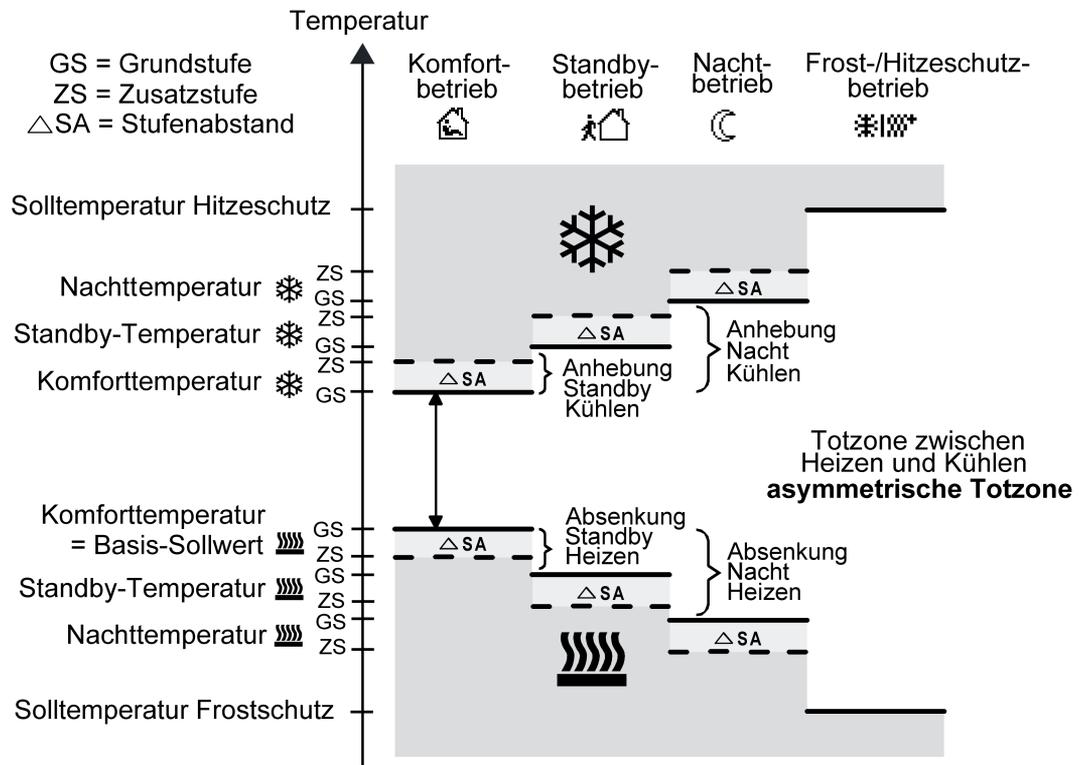
Bild 53: Solltemperaturen in der Betriebsart "Grund- und Zusatzheizen und -kühlen" mit asymmetrischer Totzone
