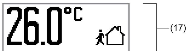
Bild 55: Beispiel für eine Grundanzeige mit einem Anzeigebereich (Raumtemperatur, Betriebsmodusanzeige)
