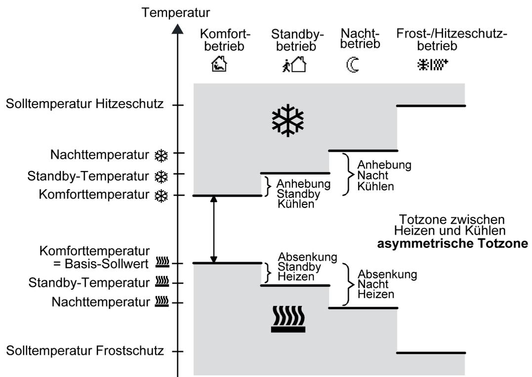
Bild 51: Solltemperaturen in der Betriebsart "Heizen und Kühlen" mit asymmetrischer Totzone
