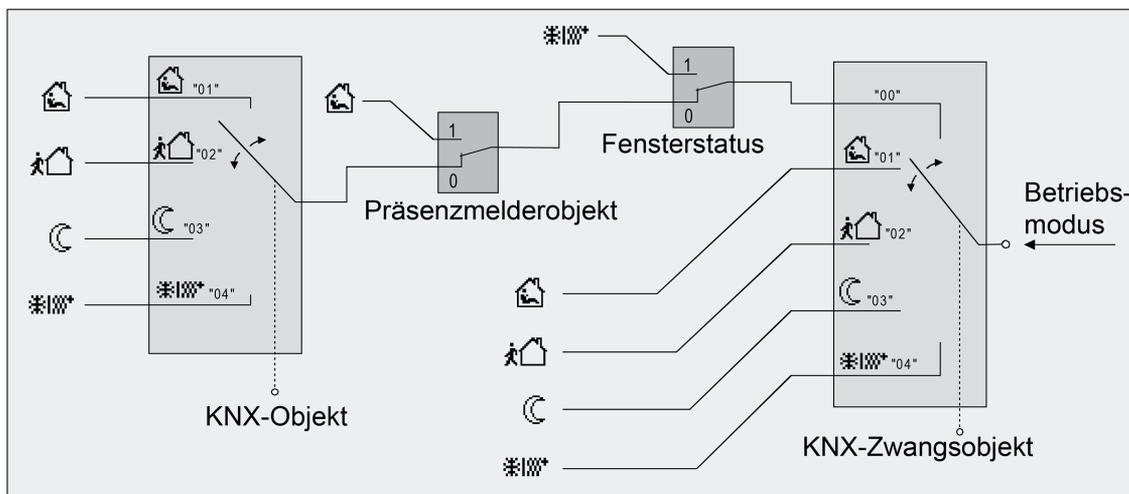
Bild 45: Betriebsmodusumschaltung durch KONNEX Objekt mit Präsenzmelder
