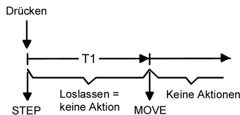
Bild 27: Bedienkonzept "Kurz - Lang"
