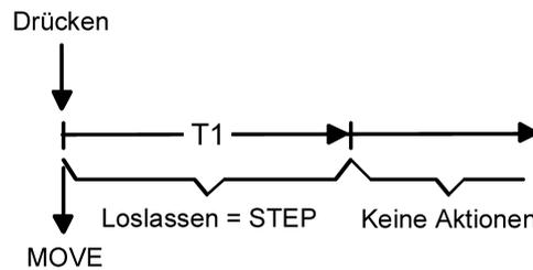
Bild 26: Bedienkonzept "Lang – Kurz"
