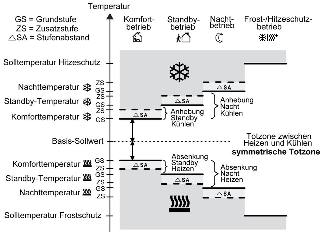
Bild 52: Solltemperaturen in der Betriebsart "Grund- und Zusatzheizen und -kühlen" mit symmetrischer Totzone
