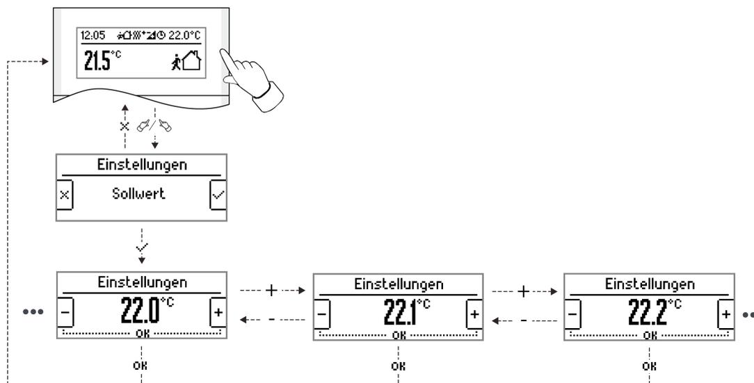
Bild 8: Menübedienung zur Sollwertverschiebung am Beispiel einer Übernahme der Sollwertverschiebung durch "OK"
