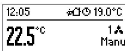
Bild 70: Beispiel für eine Lüfterstufenanzeige im manuellen Betrieb
