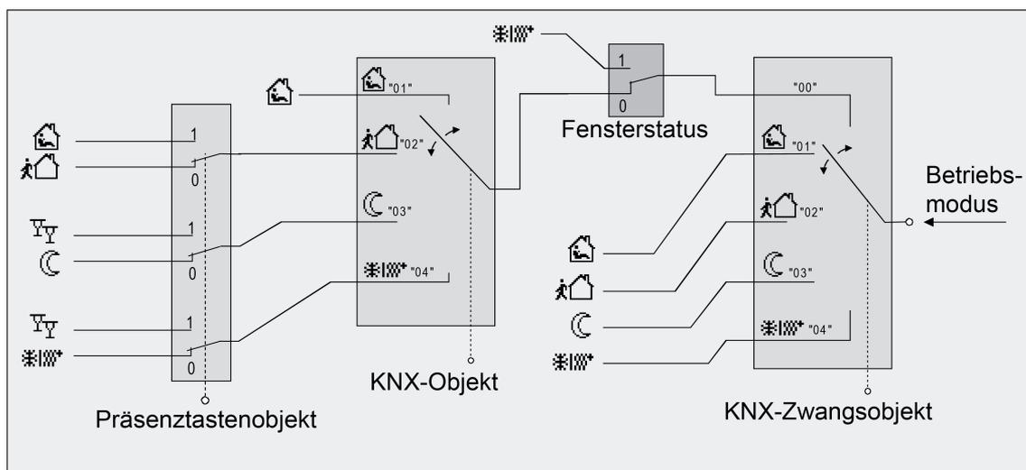
Bild 44: Betriebsmodusumschaltung durch KONNEX Objekt mit Präsenztaste
