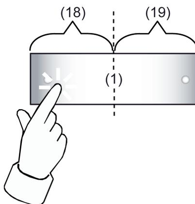
Bild 23: Beispiel für eine Tastenbetätigung bei konfigurierter Zweiflächenbedienung
