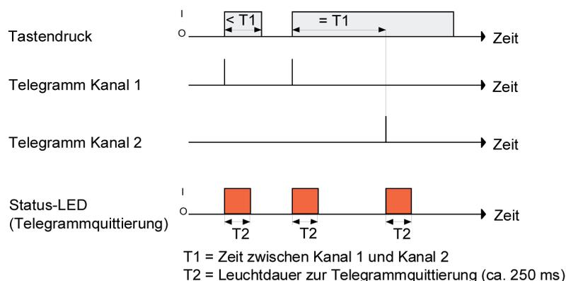
Bild 32: Beispiel zum Bedienkonzept "Kanal 1 und Kanal 2"
