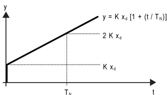
Bild 40: Funktion der Stellgröße einer PI-Regelung
