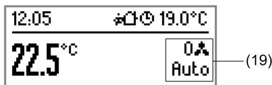
Bild 57: Beispiel einer 2-Bereichs-Anzeige mit Raumtemperatur in der Menüfläche und Lüfterstufenanzeige
