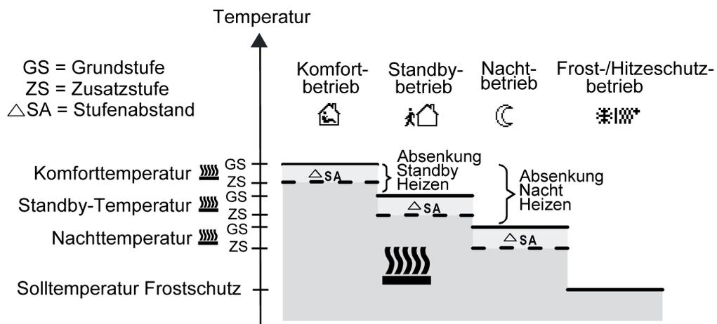
Bild 47: Solltemperaturen in der Betriebsart "Grund- und Zusatzheizen"
