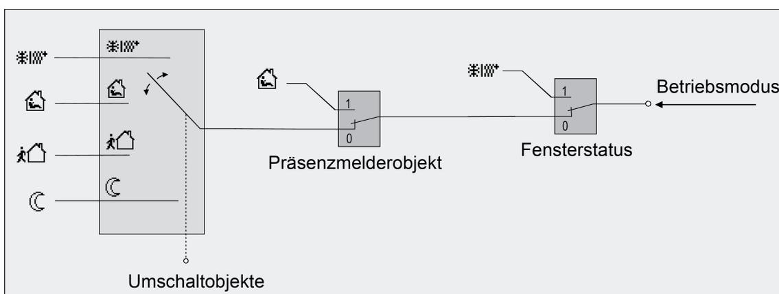
Bild 43: Betriebsmodusumschaltung durch 4 x 1 Bit Objekte mit Präsenzmelder
