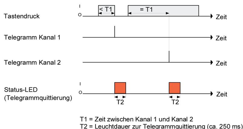
Bild 31: Beispiel zum Bedienkonzept "Kanal 1 oder Kanal 2"
