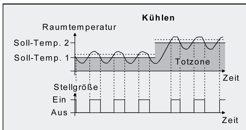
Bild 39: 2-Punkt-Regelung für Mischbetriebsart "Heizen und Kühlen" bei aktivem Kühlbetrieb
