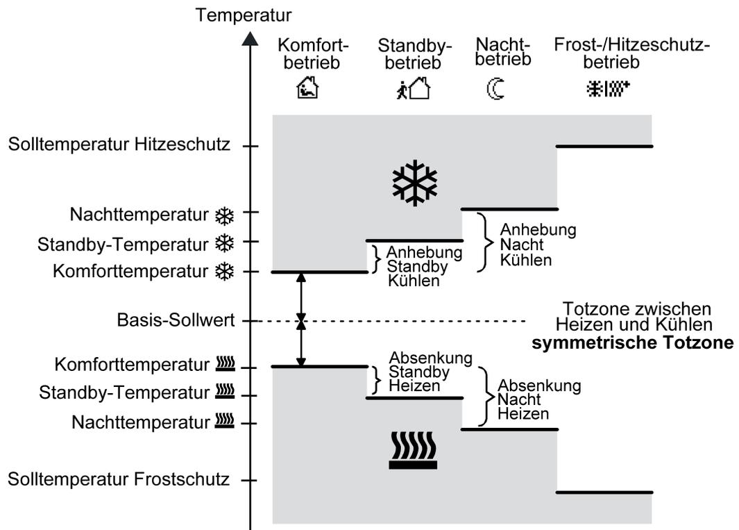
Bild 50: Solltemperaturen in der Betriebsart "Heizen und Kühlen" mit symmetrischer Totzone
