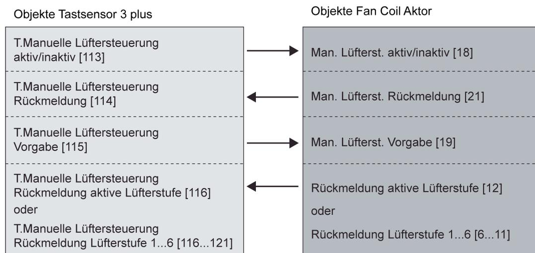
Bild 68: Kommunikationsobjekte der manuellen Lüftersteuerung (1-zu-1 Verbindung mit funktionsgleichen Objekten des Fan Coil Aktors)
