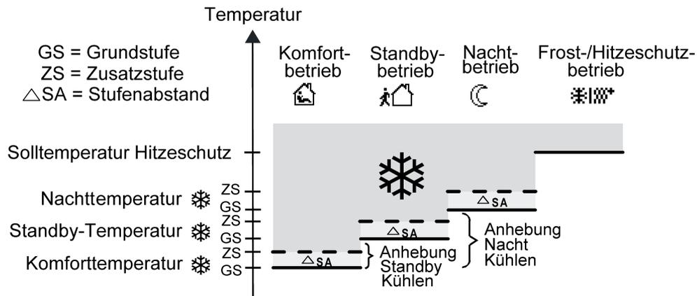
Bild 49: Solltemperaturen in der Betriebsart "Grund- und Zusatzkühlen"
