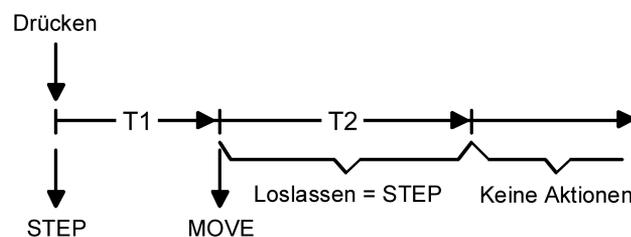
Bild 25: Bedienkonzept "Kurz-Lang-Kurz"
