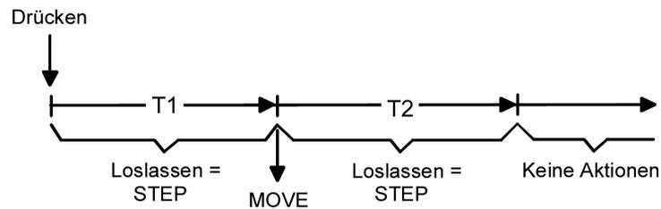
Bild 28: Bedienkonzept "Lang – Kurz oder Kurz"
