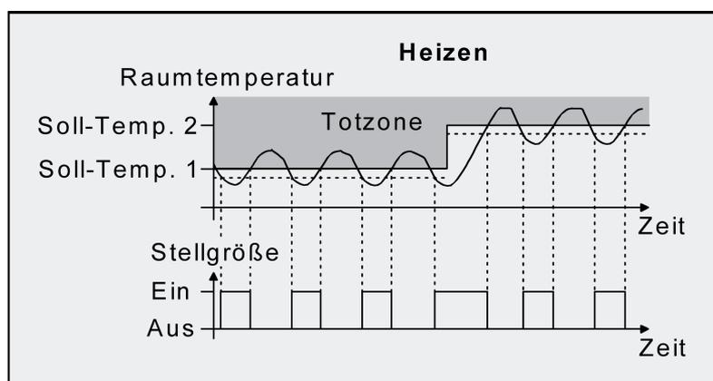
Bild 38: 2-Punkt-Regelung für Mischbetriebsart "Heizen und Kühlen" bei aktivem Heizbetrieb
