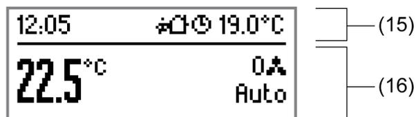
Bild 54: Beispiel für eine Grundanzeige mit zwei Anzeigebereichen (Uhrzeit, Solltemperatur, Raumtemperatur, Lüfterstufenanzeige)
