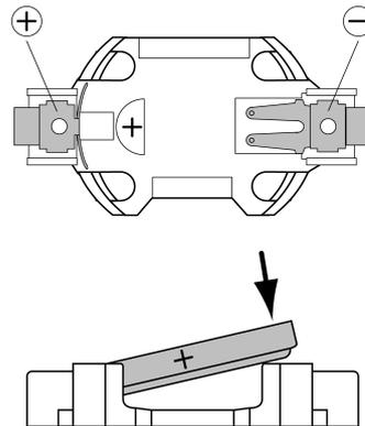
Bild 3: Batterie einlegen
