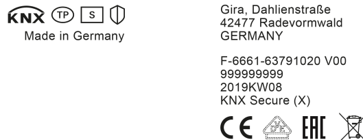
Bild 9: Beispiel einer Gerätebeschriftung eines KNX Data Secure fähigen Geräts
